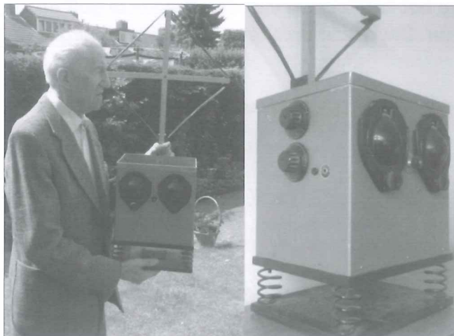
Maas met de zelfgebouwde ontvanger voor de kruispeiling
